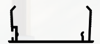
Z.CAR. S carter / montante di chiusura per guide GD.AL 75x45 S e GD.AL 47x47 Z
